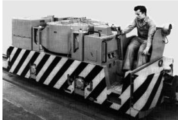
Bild 1: Gyro-Lokomotive Maschinenfabrik Oerlikon 1955 (Grubenlokomotive)
