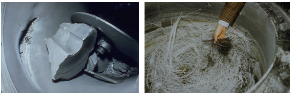
Bild 3: Bruchstücke von geborstenen Rotoren
